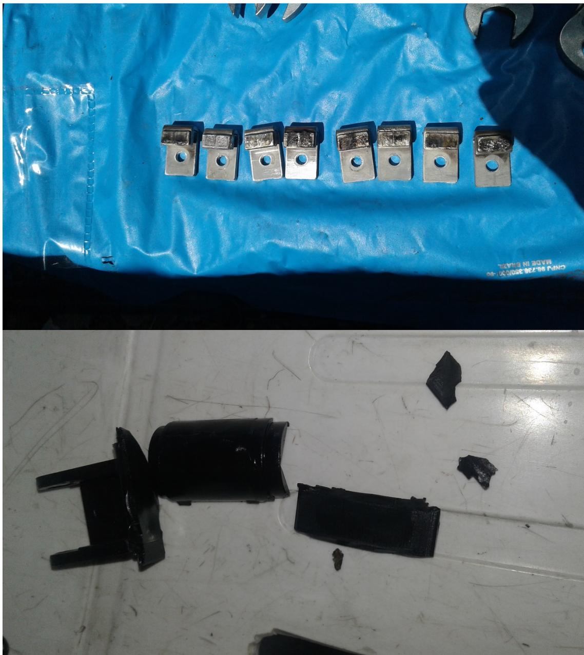
3.1 Após a manutenção corretiva foram reparados os contatos, mas o técnico informou que isso seria uma solução emergencial e que seria necessário a aquisição de uma nova chave, pois os contatos da chave original são de um composto em liga de prata com projeto de alta pressão que pode suportar milhares de ciclos de comutação.
